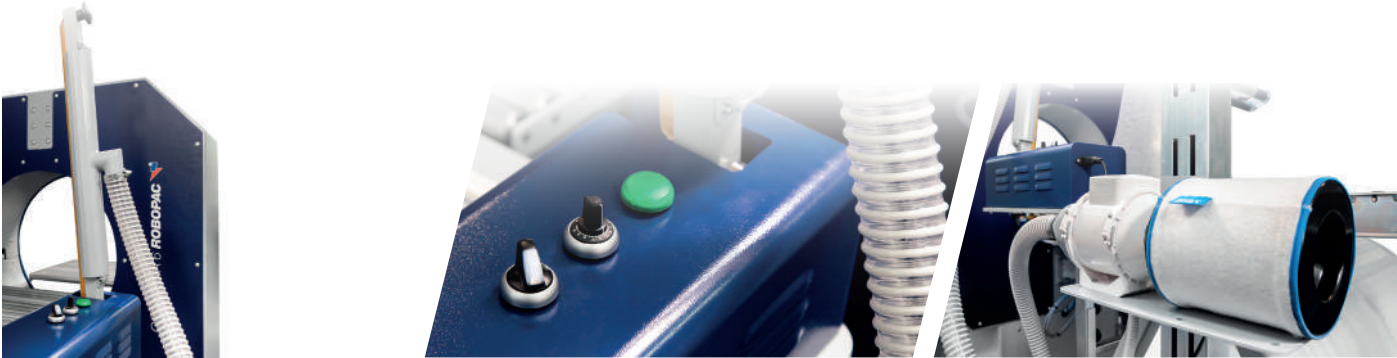
SALDATURA MANUALE AD IMPULSI / MANUAL IMPULSE WELDING Saldatura manuale del film plastico sul prodotto e regolazione del tempo di saldatura. Sistema di aspirazione fumi mediante filtro. Manual welding of the plastic film on the product and adjustment of the welding time. Fume extraction hood with filter.
