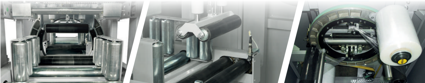
GUIDE LATERALI A RULLI IN ENTRATA E USCITA / ICOMING AND OUTGOING SIDE ROLLER GUIDES GRUPPO PRESSORI PNEUMATICI PNEUMATIC PRESSER UNIT GRUPPO PORTABOBINA FILM CARRIAGE
