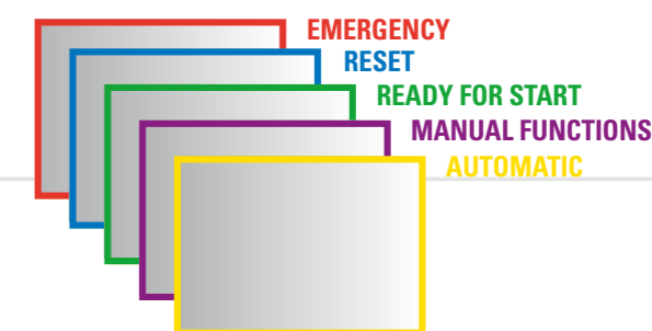
BORDO COLORATO STATO MACCHINA COLOR FRAME FOR MACHINE STATUS
